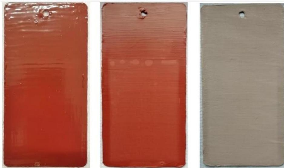
Makroskopische Aufnahmen der beschichteten Probenplatten mit den drei Beschichtungssystemen nach fünf Wochen in der QUV-Prüfmaschine (Macroscopic images of the coated sample plates with the three coating systems after five weeks in the QUV testing machine.)
